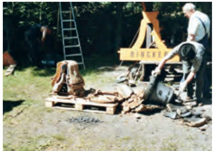
Eine neue Betglocke wurde zum 2. „Ilfelder Harzfest“ im Juni 2005 von der Firma Rincker (älteste Glocken- und Kunstgießerei aus Sinn) auf der Weidentalswiese gegossen. Das Foto rechts unten zeigt auf der Europalette ein Demonstrationsmodell des Glockengießens und rechts das Ausformen der Glocke aus der „verlorenen Sandform“.
